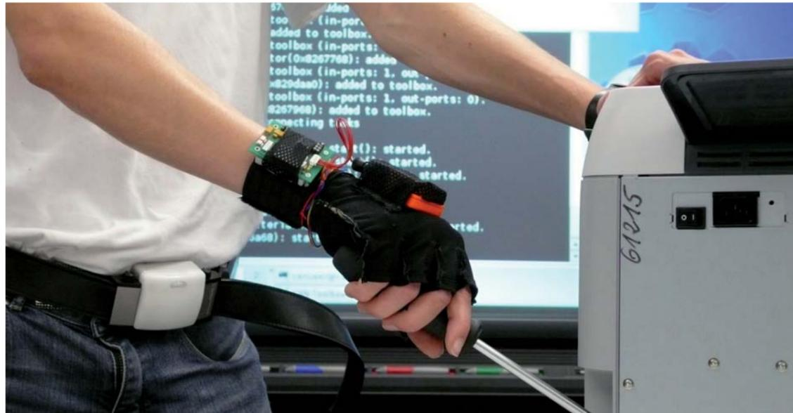
Mit Hilfe von Bewegungssensoren können alltägliche Handgriffe wie z.B. das Benutzen eines Schraubenziehers erfasst und anschließend analysiert werden.
