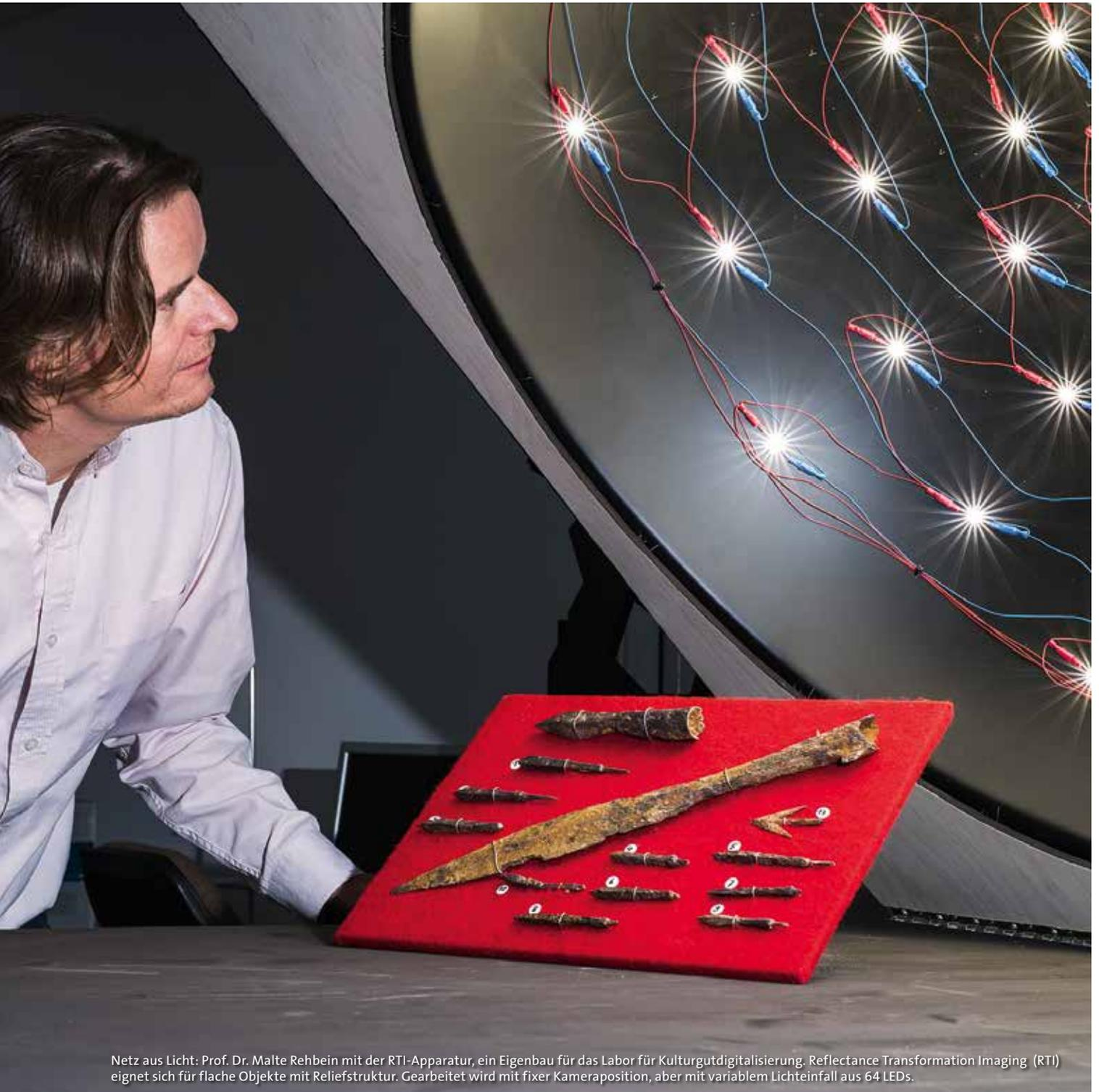
Netz aus Licht: Prof. Dr. Malte Rehbein mit der RTI-Apparatur, ein Eigenbau für das Labor für Kulturgutdigitalisierung. Reflectance Transformation Imaging (RTI) eignet sich für flache Objekte mit Reliefstruktur. Gearbeitet wird mit fixer Kameraposition, aber mit variablem Lichteinfall aus 64 LEDs.
