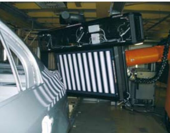
Qualitätskontrolle einer lackierten Karosserie mittels des neuen, von Micro-Epsilon und FORWISS entwickelten Verfahrens.
