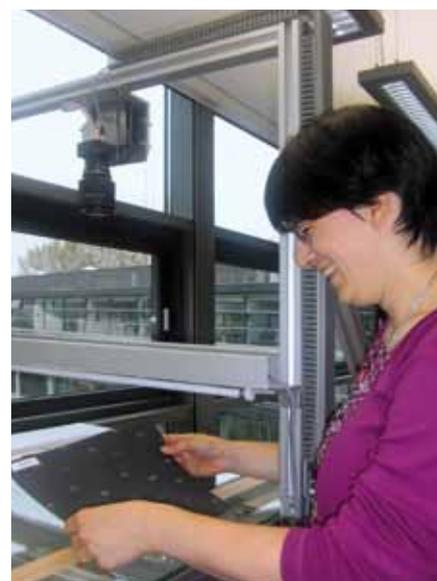
Konzentriert kontrolliert Eva Lang von FORWISS am Prototyp ein Stoffmuster. Ein Inspektionssystem soll künftig eine Vielzahl von Mustern automatisch auf Fehler überprüfen.
